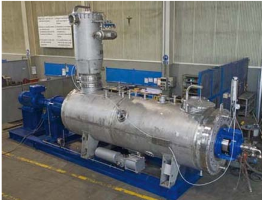
Termomix ® TM 6000 Schaufeltrockner/Reaktor mit flach ausgeführten Deckeln, Antriebsleistung 160 kW, flüssigkeitsgeschmierte Gleitringdichtungen, Brüdenfilter Filteroberfläche 12 m 2 .
