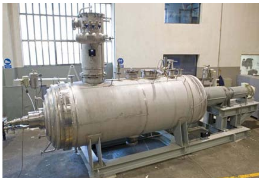
Termomix ® TM 12000 Schaufeltrockner/Reaktor mit als Klöpperböden ausgeführten Deckeln, produktbenetzte Teile spiegelpoliert, flüssigkeitsgeschmierte Gleitringdichtungen.
