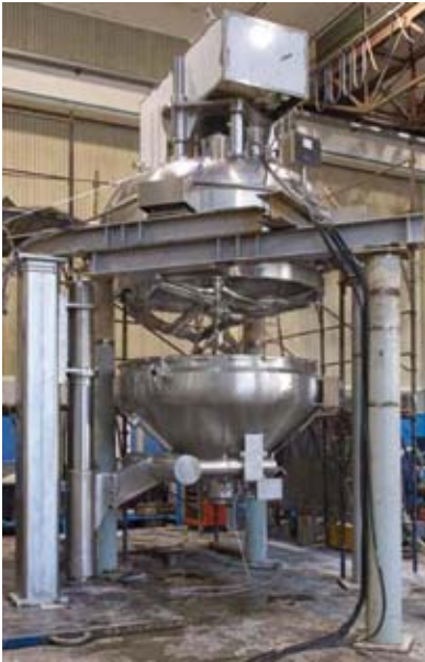
Condry ® TDC 3500 mit abgesenktem konischem Unterteil
