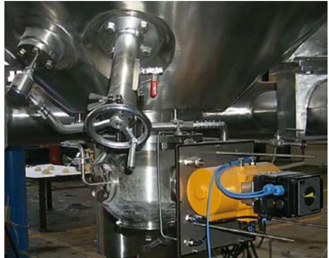
Kugelsegmentventil mit aufblasbarer Dichtung für den Trockenprodukt-Austrag, angebracht am Konusende des Behälterunterteils. Diese Armaturen sind in Mischbauweise verfügbar, z.B. feuchtproduktbenetzt in Hastelloy, trockenproduktbenetzt in Edelstahl.
