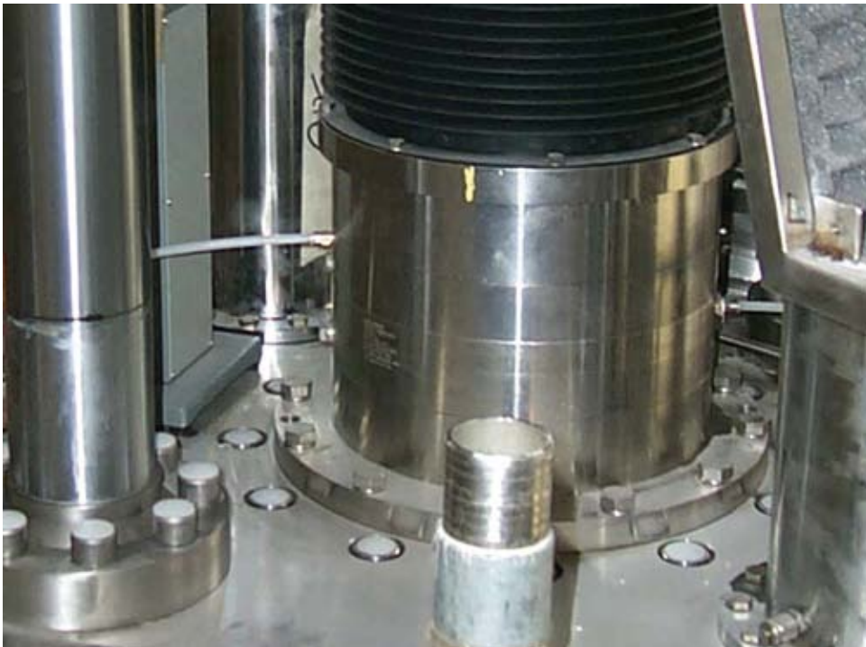
Links oben: Ansicht der Gleitringdichtung-Installation eines Condry® Vertikal-Vakuum-Trockners ausgerüstet mit doppeltwirkender gasgeschmierter (Lift-Off) Gleitringdichtung in aseptischer Ausführung mit den inneren Dichtringen im Behälter liegend. Drehende Dichtringe aus SiC, stationäre Gleitringe aus SiC mit DLC beschichtet.
