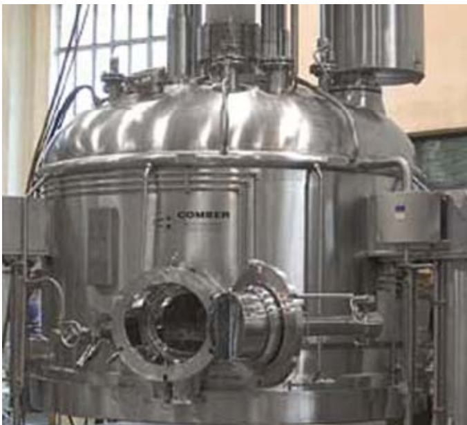
Filterbehälter mit cGMP-gerechter Vorverdrahtung.
