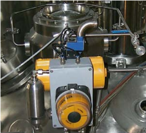
Kugelsegmentventil mit aufblasbarer Dichtung für den Feuchtprodukt-Eintrag, angebracht am Eintragsflansch auf dem Trockner-Oberteil. Als Alternative können hier auch Absperrklappen z.B. mit PTFE-Auskleidung eingesetzt werden.
